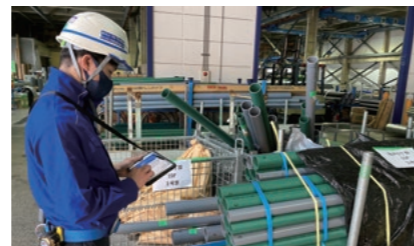
工場加工した配管材料を確認
